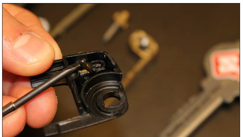
...tills den gått ca 1 varv och fjädern inte längre spänner.
