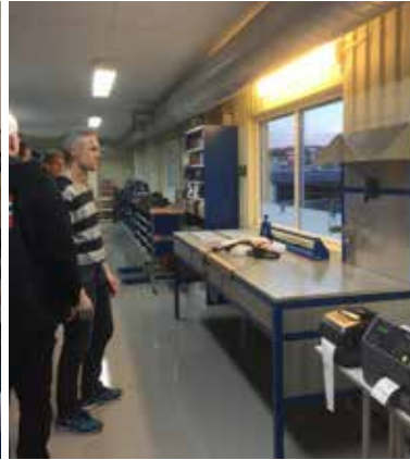
En specialbyggd packbänk med inbyggd våg och bandare för paket är på plats, Mårten och Mats från Prodib Sverige ligger under bänken och fäster upp kablar - snyggt ska det vara också. Allt är byggt enligt Toyota metoden 5S, allt kommer i sekvensföljd och inga onödiga saker får ligga framme.
