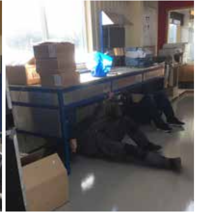
En specialbyggd packbänk med inbyggd våg och bandare för paket är på plats, Mårten och Mats från Prodib Sverige ligger under bänken och fäster upp kablar - snyggt ska det vara också. Allt är byggt enligt Toyota metoden 5S, allt kommer i sekvensföljd och inga onödiga saker får ligga framme.
